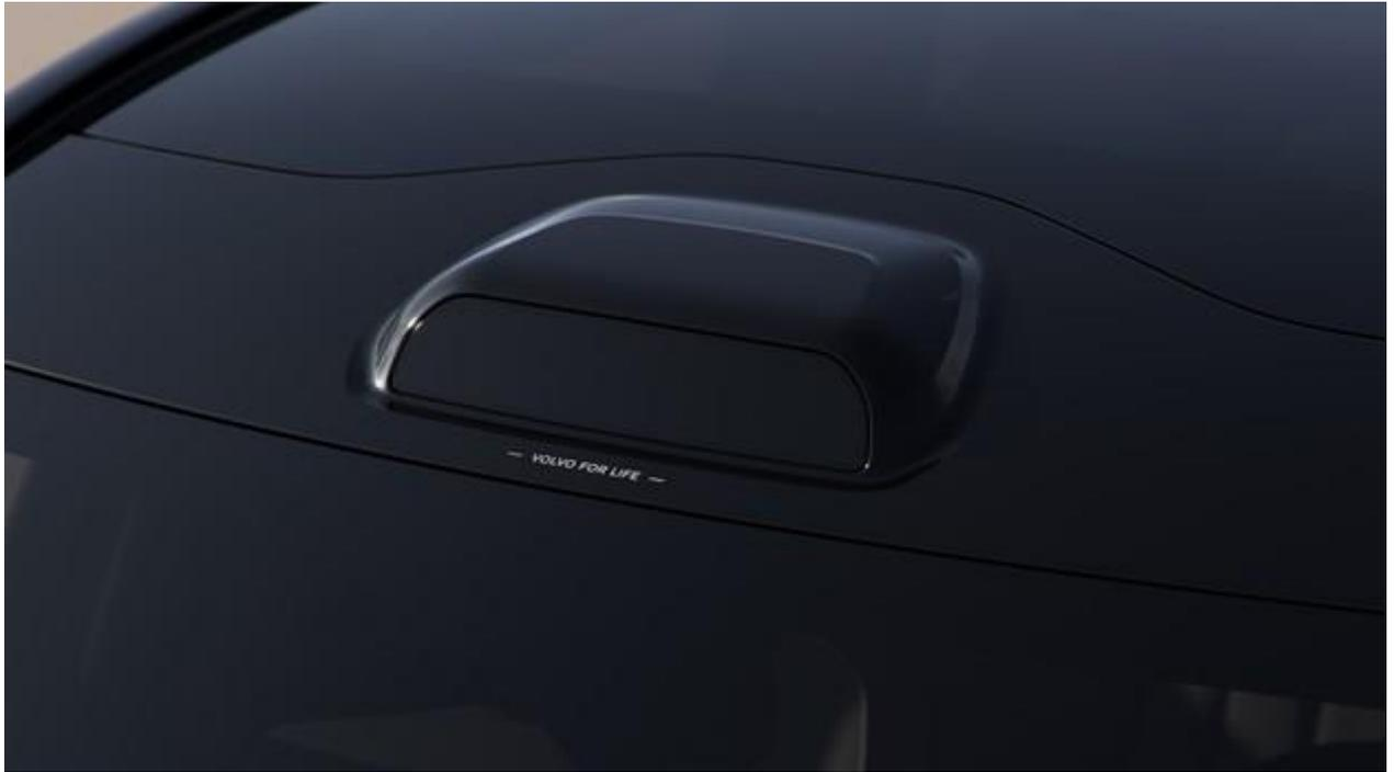
エクステリアデザイン担当責任者のT・ジョン・メイヤーは、「LiDARを見栄えよく、かつ安全性能を最大限発揮する形で組み込むことは、デザイン上のチャレンジでした。LiDARはクルマの目であり、グリル周辺に設置することもできますが、それは膝の上に目を置くのと同じことで、できるだけ頭の上に設置し、できるだけ多くのものを見ることができるようにする方がはるかに理にかなっているのです。そのため、エンジニアと一緒に、ルーファインに統合してその効果を最大化することにしたのです」と述べています。
